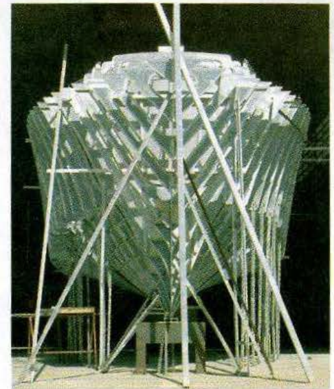
■ La structure du yacht est réalisée en sealium, un alliage d'aluminium très léger qui permet de réduire la consommation de carburant.
